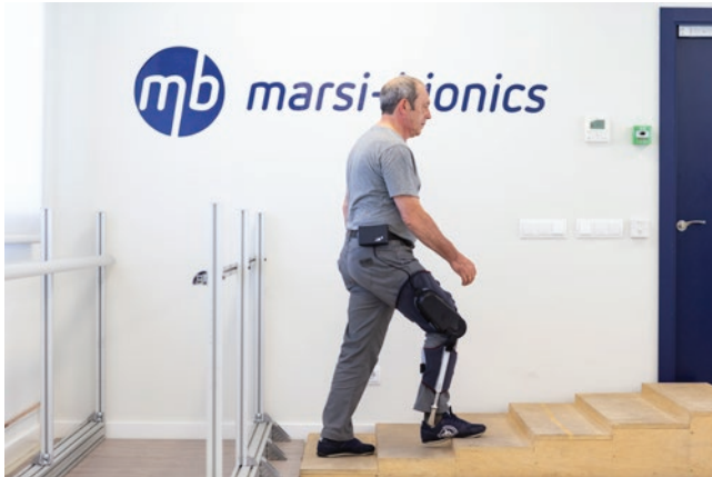
» Uporaba aktivnega kolena MAK podjetja Marsi Bionics. | Vir: Marsi Bionics
